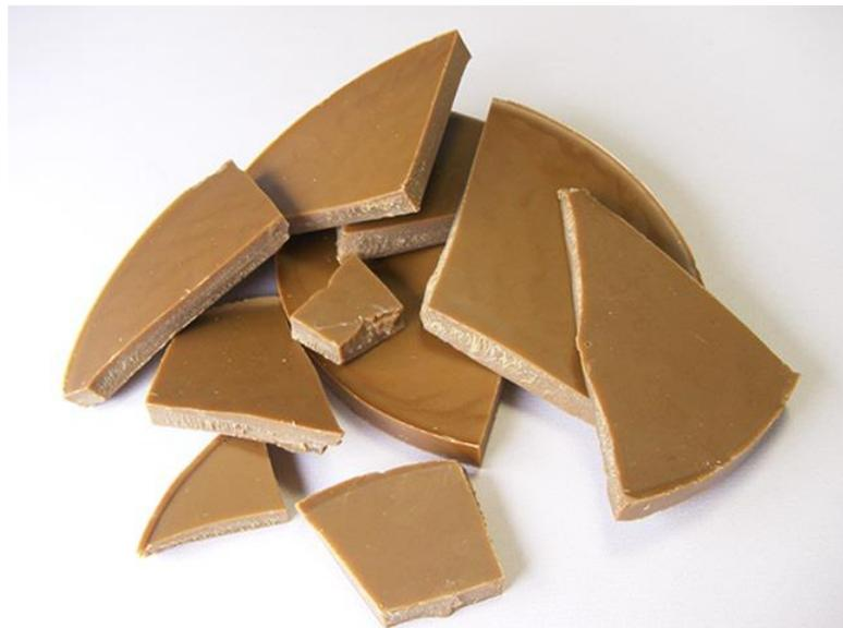
煮えたものを布で濾して不純物を取り除き、固めたものが原型制作用のミツローになります。
